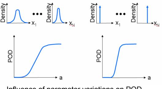
Influence of parameter variations on POD Left: Distribution of input parameters Right: Fixed input parameters
