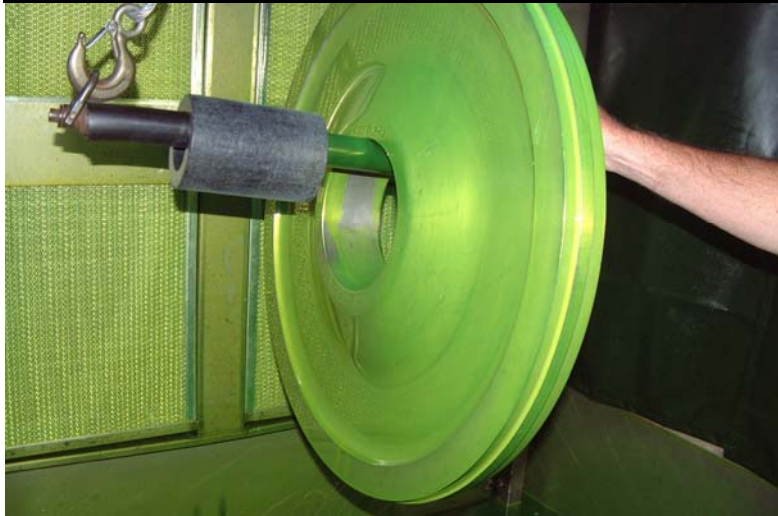
Level 4, PE Penetrant, 20 min dwell
